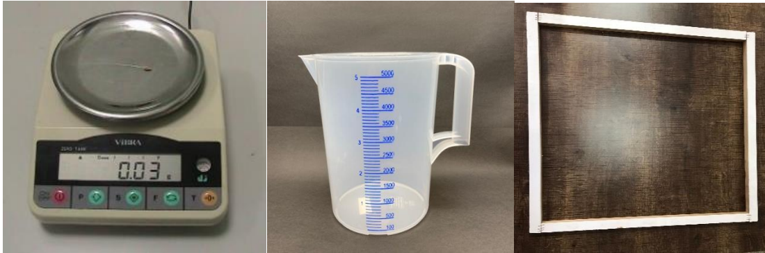
Şekil 6. Çalışmada kullanılan hassas terazi, dereceli kap ve 0.5 m x 0.5 m çerçeve
