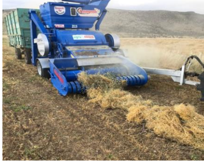
Şekil 10. Traktörle çekilen Özapalı firmasına ait toplar- döver harman makinası
