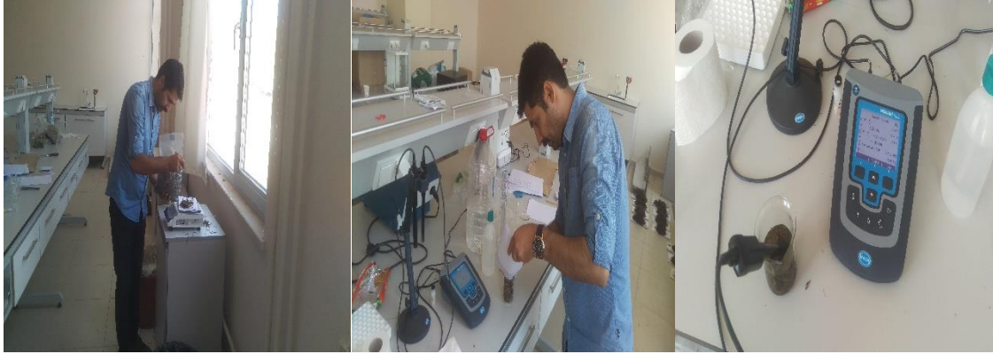
Resim 2. Silaj pH değerlerinin ölçülmesi
